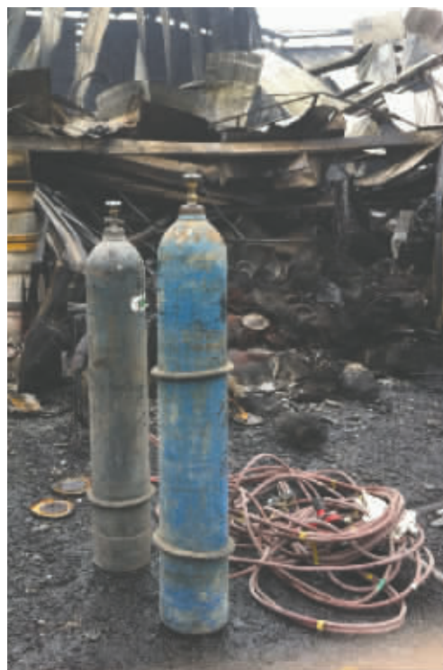
最先起火的107铺外有两个电焊氧气罐
